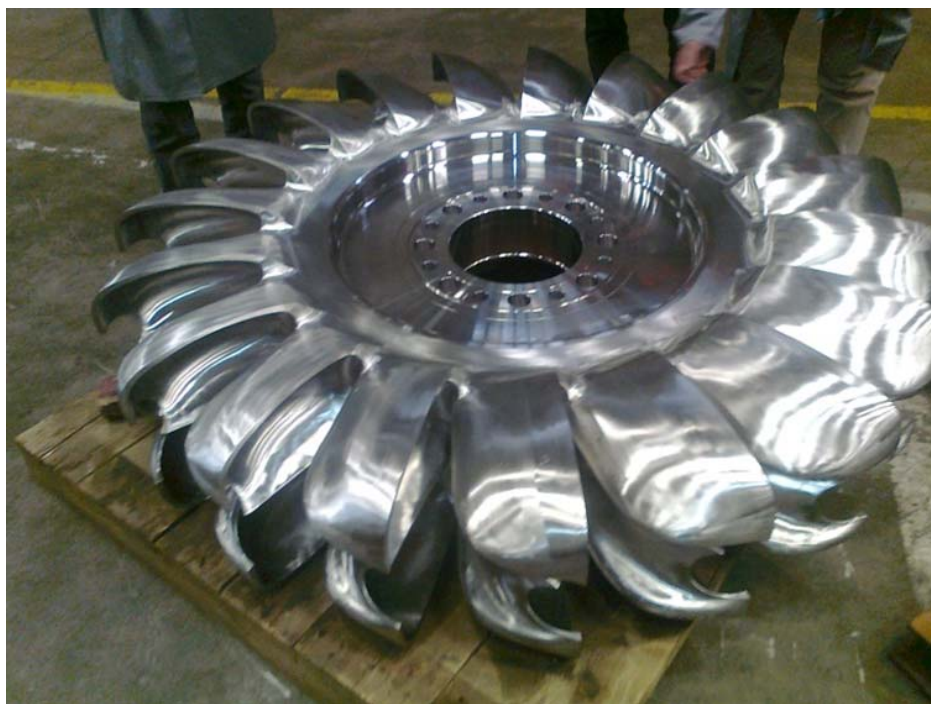
Oběžné kolo Peltonovy turbíny VE Kwoiek Creek
